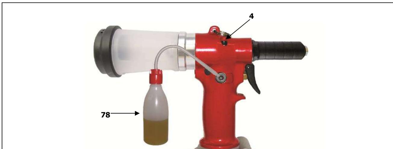
Il ripristino dell'olio del circuito oleodinamico si rende necessario dopo un lungo periodo di lavoro, quando si avverte un calo di corsa dell'attrezzo.
