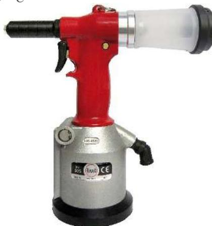
Se durante l'utilizzo della rivettatrice Riv 505 si verifica che il chiodo del rivetto non viene aspirato perché è molto sottile, occorre sostituire la BOCCOLA D'ASPIRAZIONE X RIVETTI STRUTTURALI Ø 4,00 E STANDARD DA Ø 4,8 A 6,0 Cod. **4698500**, RIF. **11**) con la BOCCOLA D'ASPIRAZIONE X RIVETTI DA Ø 2,5 A 4,0 (Cod. **4698400**, RIF. **12**), adatto per rivetti fino ø 4,0.
