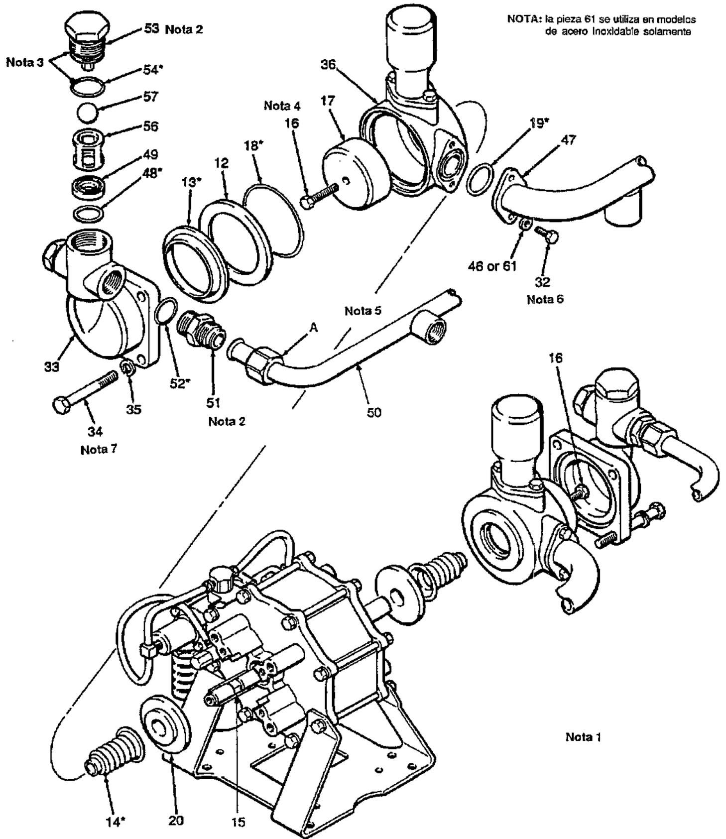
NOTA: la pieza 61 se utiliza en modelos de acero inoxidable solamente
