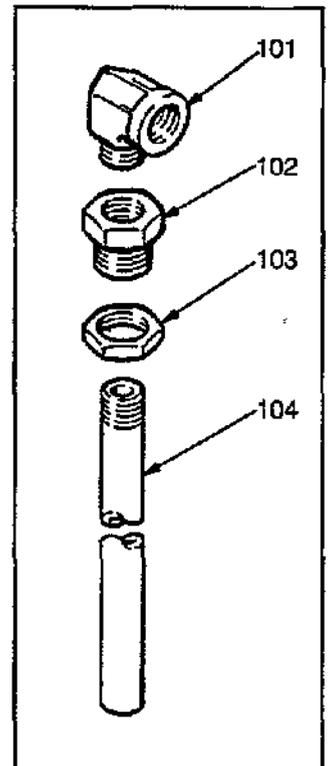
Nota 1 Para kit del tubo de retorno, sacar este tapón (218) e instalar el adaptador (102) y codo (101). Instalar el tubo (104) y tuerca (103) desde la parte inferior.
