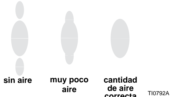
FIG. 5. Problemas del patrón de pulverización
